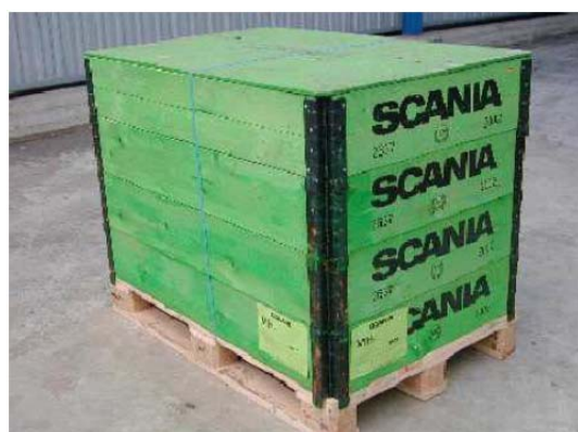
Figur 3. Exempel på generellt emballage för fordonskomponenter (poolemballage).
