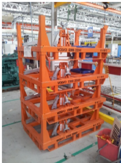
Figur 2. Exempel på specialemballage (för motorer respektive karosplåtar).
