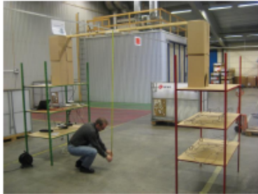
Singelantenn 2,5m över golv Avstånd till tag <2,2m
