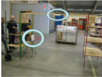
Antennhöjd över golv 0,8 resp 1,9m
