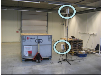
Antennhöjd över golv 1,2 resp 2,65 m
