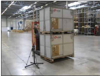
Antennhöjd över golv 1,2 resp 2,65 m
